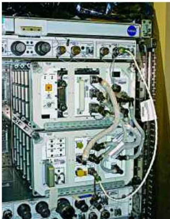
Déclic est un module dans lequel viennent s'enficher des inserts dédiés à 3 expériences de sciences de la matière.
